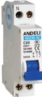
ADZ30-32 小型断路器(以下简称断路器)主要适用于交流 50Hz 或 60Hz, 额定电压 230V, 额定电流至 32A 的线路中作过载、短路保护, 同时也可以在正常情况下作为线路的不频繁转换之用, 尤其适用于工业和商业的照明配电系统。
